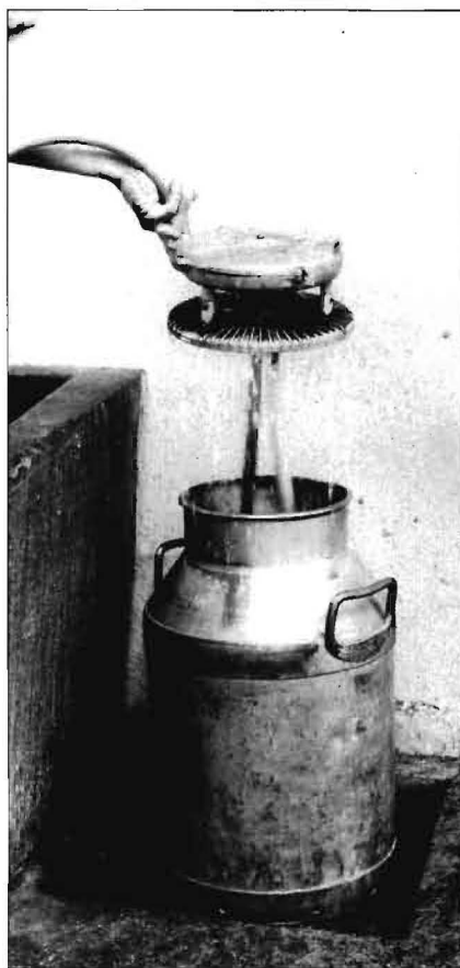
Kannenrührkühler kühlen schneller und wassersparender als Wassertröge. (Bild 7)
