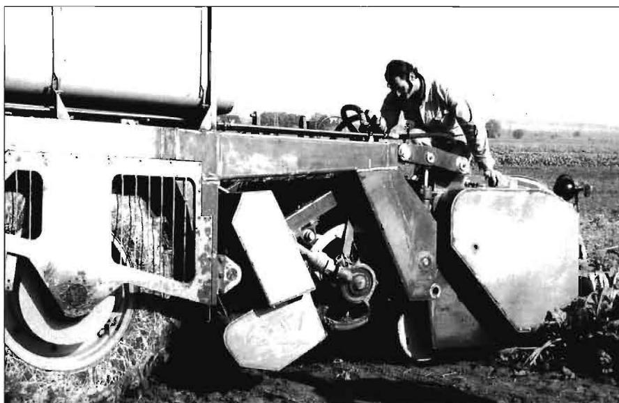
Abb. 2: Köpf- und Rodeaggregat des Betaking Bunkerköpfröders (1974)
