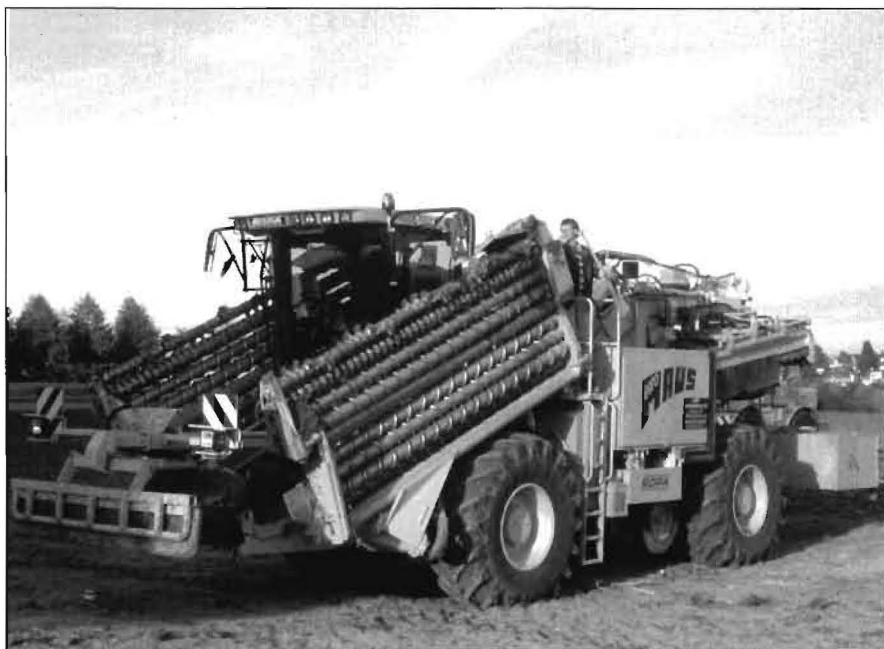
Selbstfahrender Rübenreinigungslader ROPA „euro maus“
