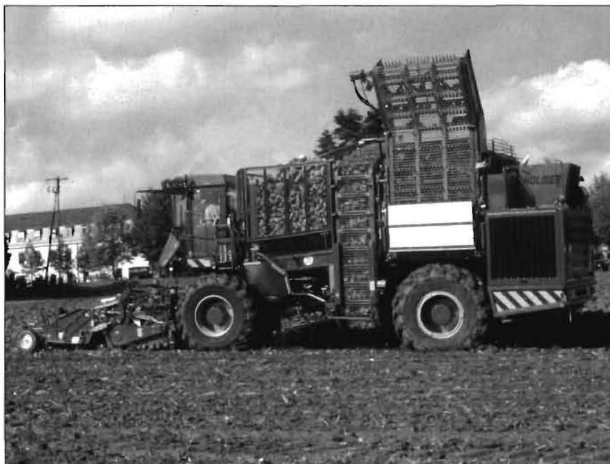
Selbstfahrender 6-reihiger Bunkerköpfer „Holmer Terra Dos“ unterhalb von Schloss Hohenheim
