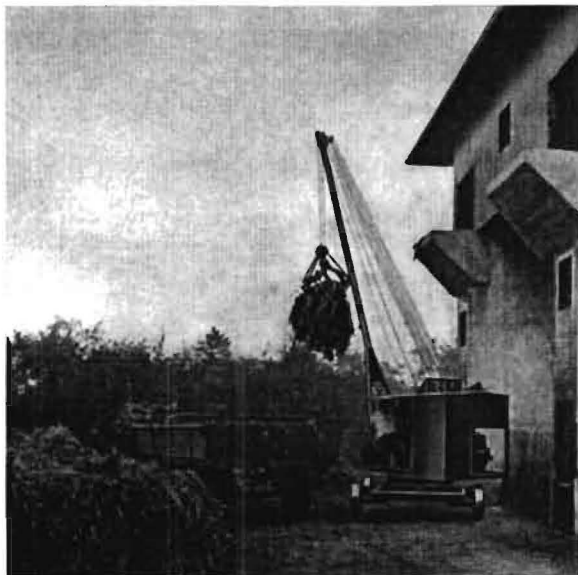
Abb. 603 FUCHS-Lader D1 (frühere Ausführung) mit Greifzange. Rübenblätter werden vom Wagen abgeladen und gleichzeitig die Silos in einem Arbeitsgang gefüllt.
