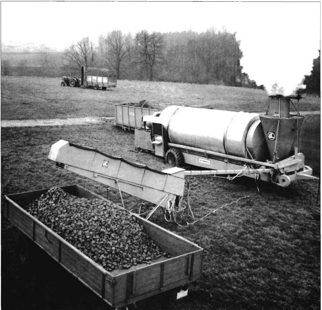
Der CLAAS-APOLLO beim Trocknen, wo das zu erntende Grünfutter wächst. Im Vordergrund die trockenen gekühlten Grasbriketts (Abb. 2)
