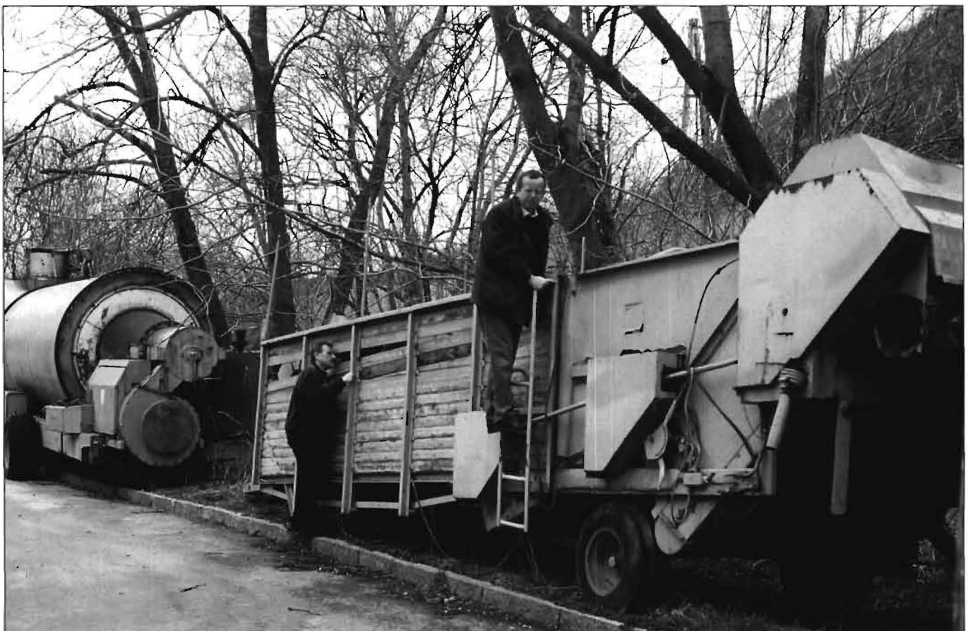
Vorratsbehälter mit automatisch gesteuerter Dosiereinrichtung zum Claas Apollo
