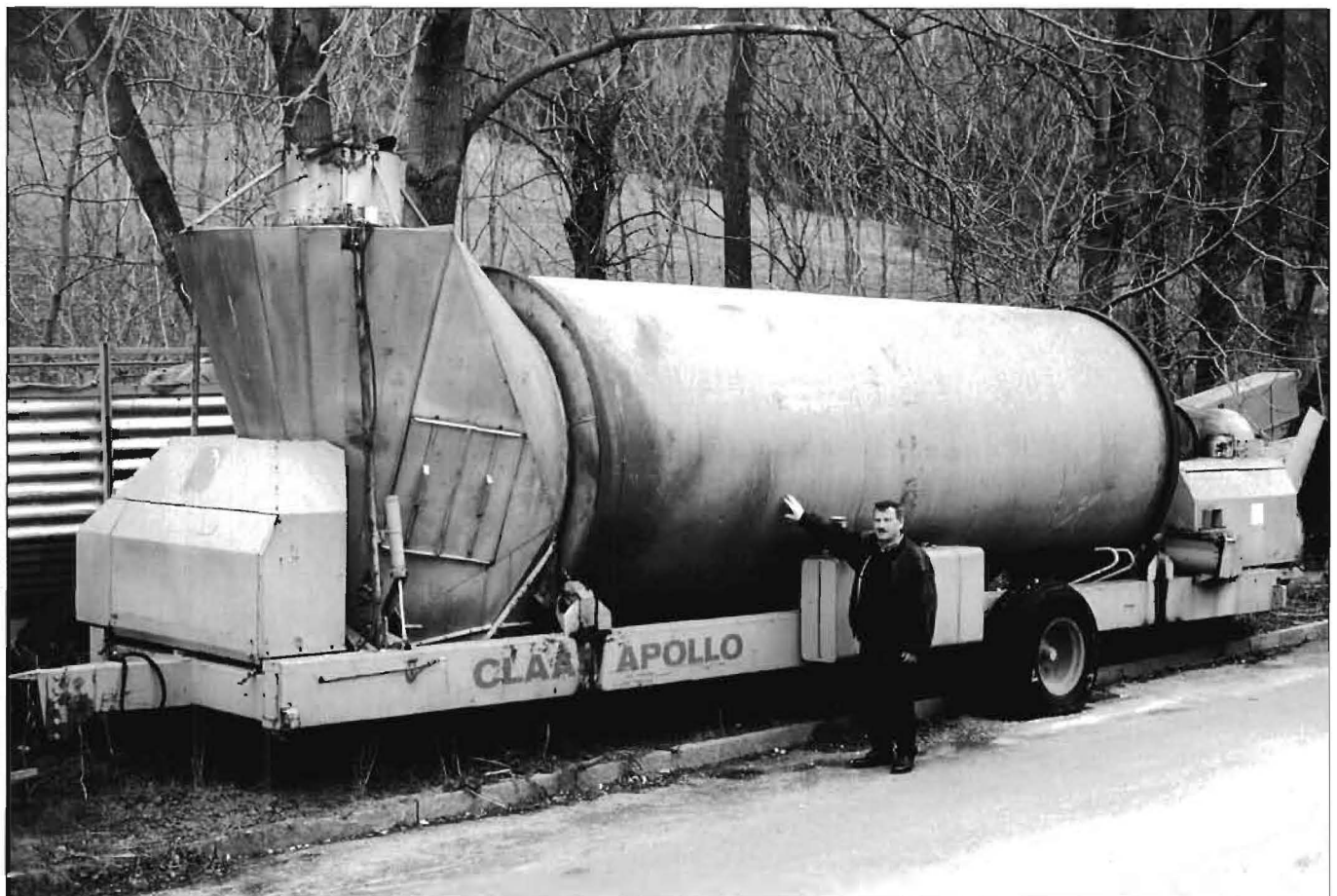
Die symbolträchtige Trocknungstrommel – Der mobile Grünfuttrockner CLAAS-APOLLO wird von einem Schlepper von Feld zu Feld versetzt
