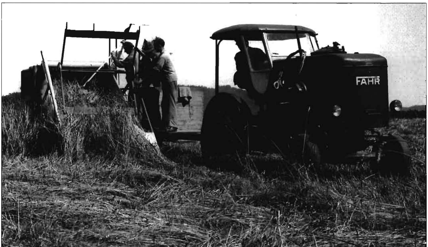
Fahr-Holzgastraktor HG 25 zieht den Prototypen eines gezogenen Mähdreschers (um 1943)
