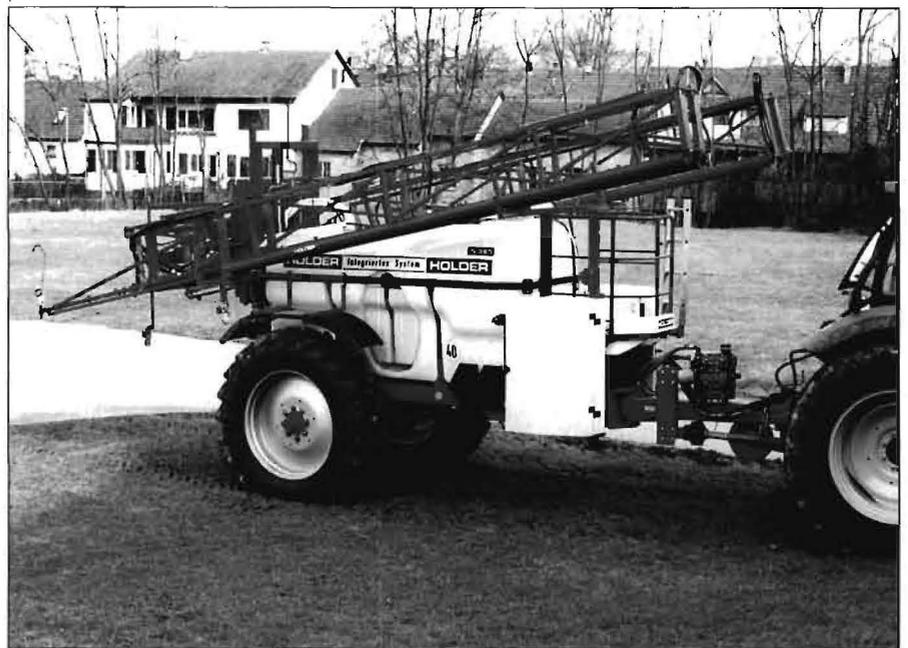
Anhänge-Spritze „IS/IN Technik“ 3600 l, 24 m Spritzgestänge (ab 2001)
