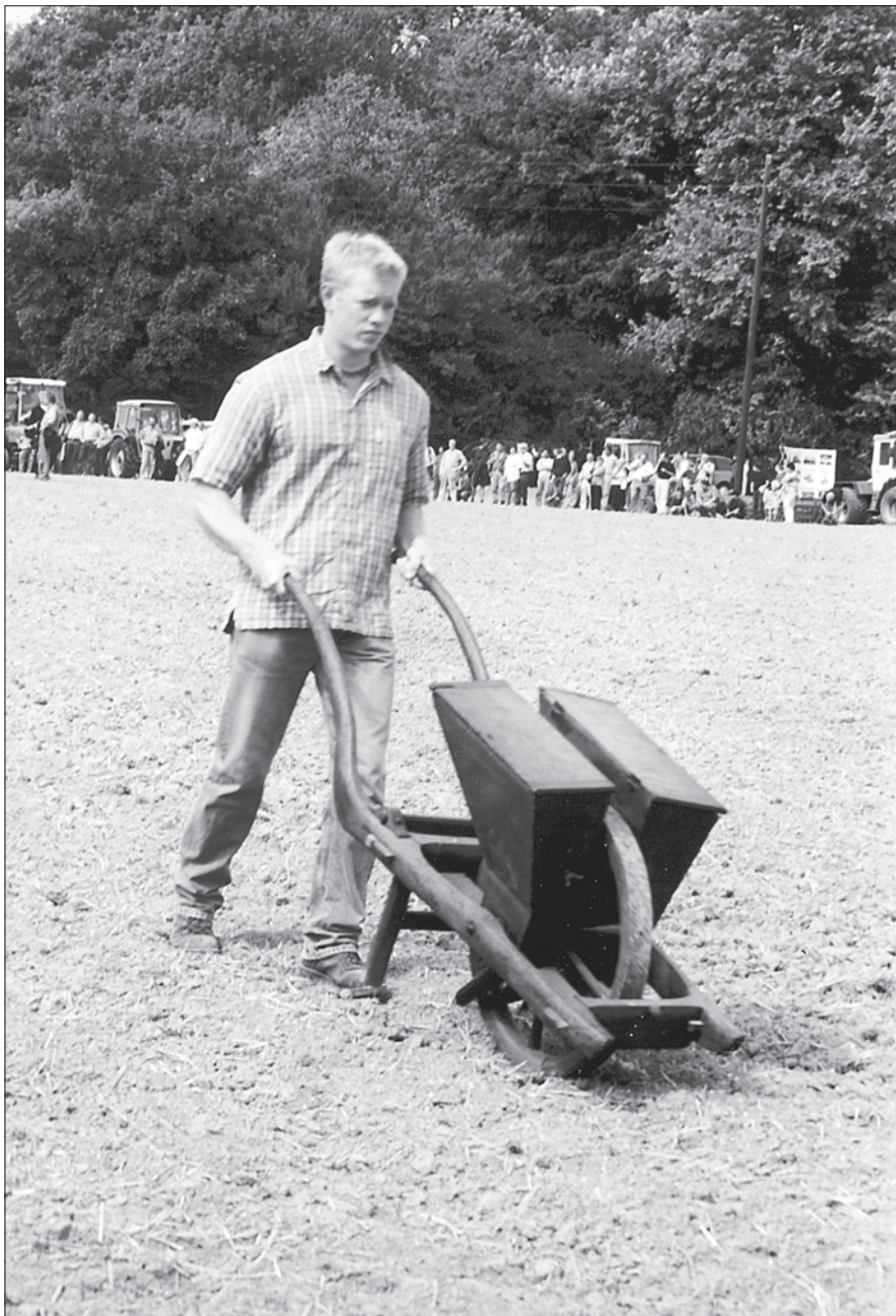
Zweireihige Hohenheimer Sämaschine aus dem Jahre 1825 bei der Vorführung im Rahmen des Hohenheimer Feldtags 2003
