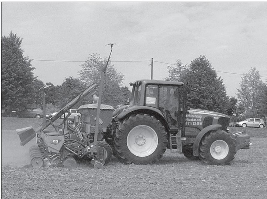
*Spezielle Maschinen für die Mulchsaat von Mais und Zuckerrüben gewährleisten präzise Saatgutablage und hohe Einsatzsicherheit.*
