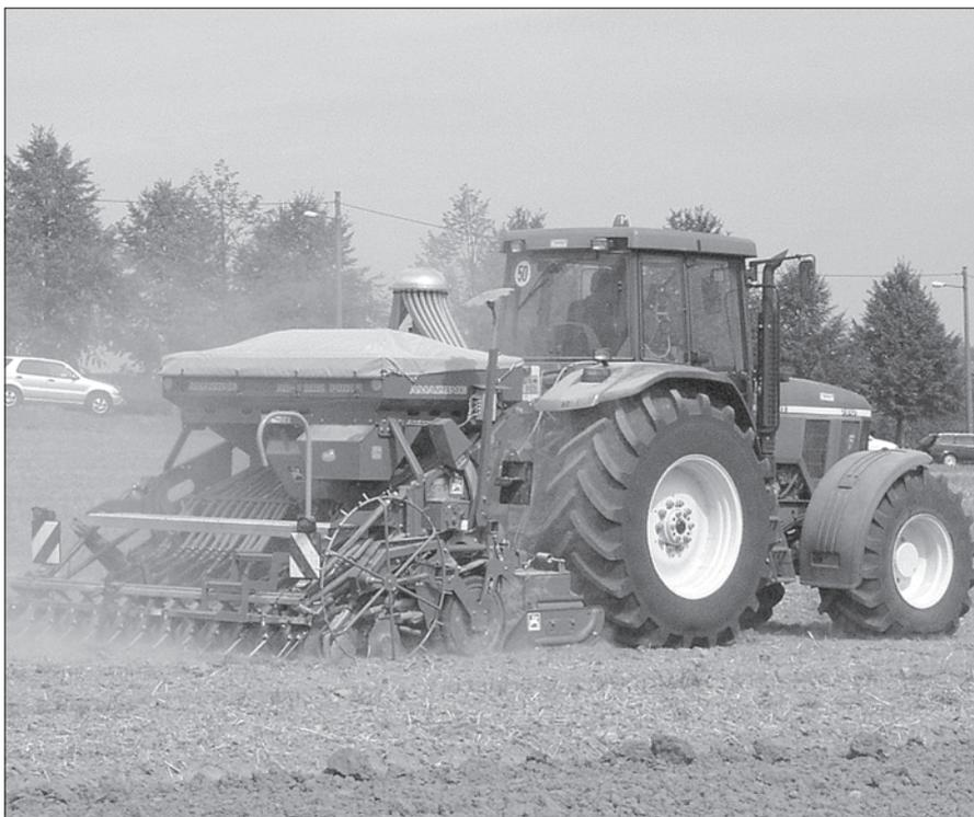
*Mit einem Kreiselgrubber kombinierte Mulchsaatmaschinen sind eine empfehlenswerte Alternative für schwere Böden mit großen Pflanzenrestmassen.*
