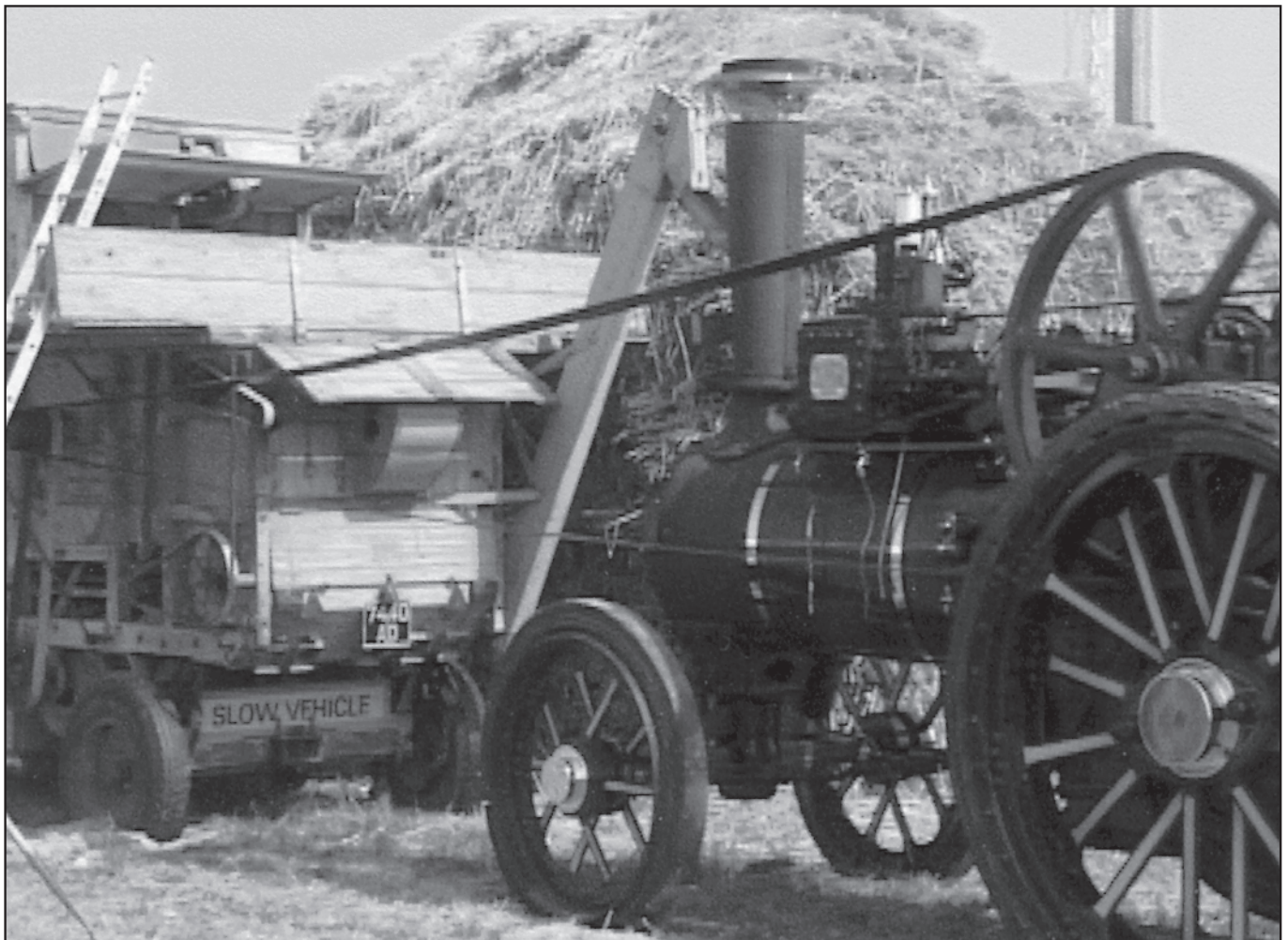
Dampfdreschen: Antrieb der Dreschmaschine durch Dampflokomotive. Great Dorset Steam Fair, GB.
