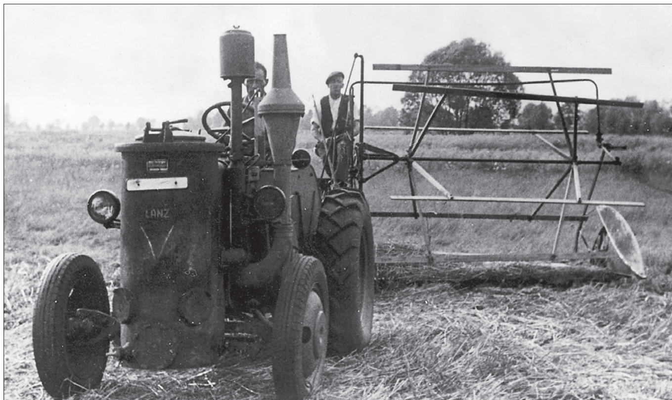
Lanz-Bulldog 25 PS mit Imbert-Generator – ein treuer Helfer der Bauern auch in schwieriger Zeit
