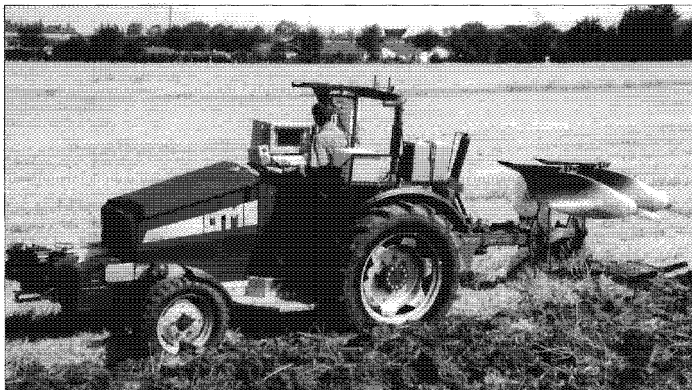
Bild 4: Der Forschungstraktor im Einsatz, hier zur Messung von Lastkollektiven beim schwerem Pflügen mit Leistungsregelung (um 1994/95). Am Steuer Bernd Vahlensieck (Foto: G. Anthuber).
