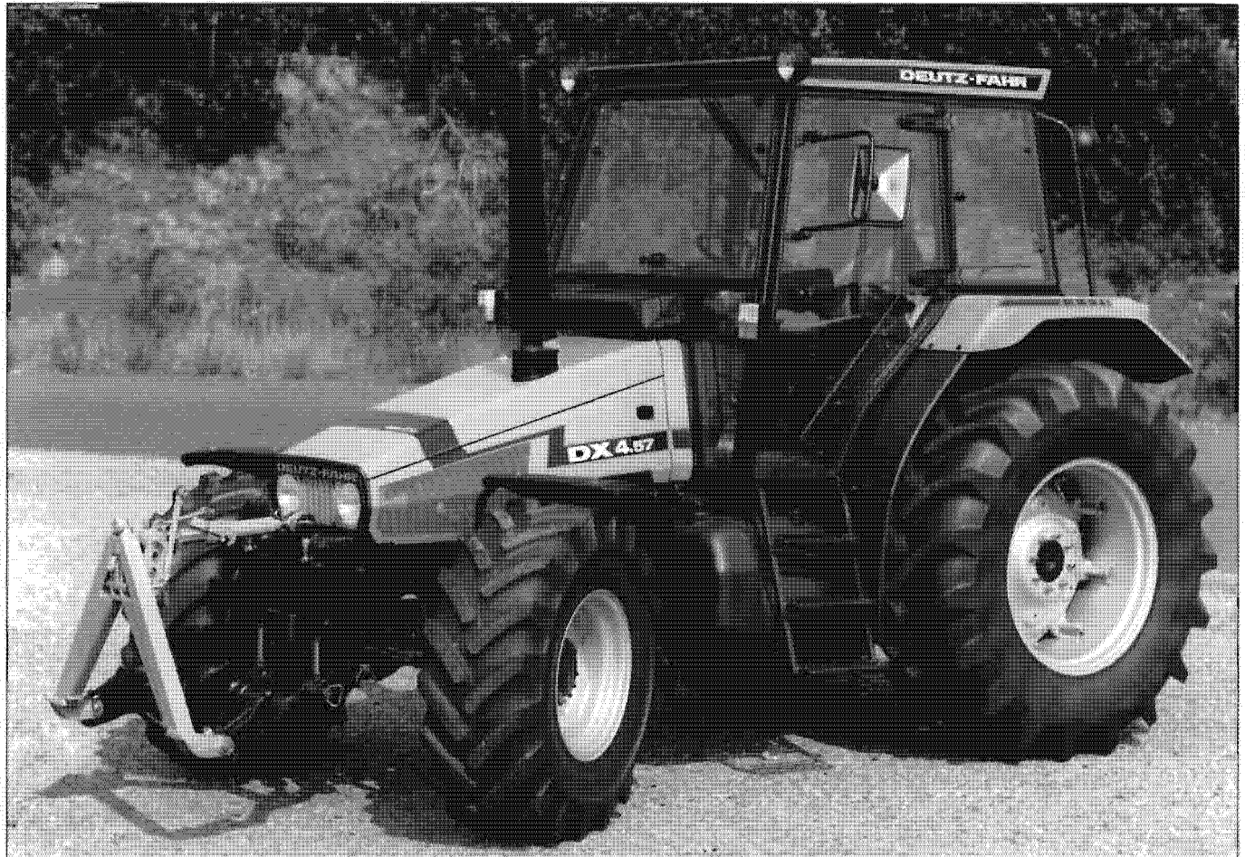
Bild 6: Deutz Traktor mit extrem abgeflachter Motorhaube 1991 (Foto: Deutz-Fahr) [22]
