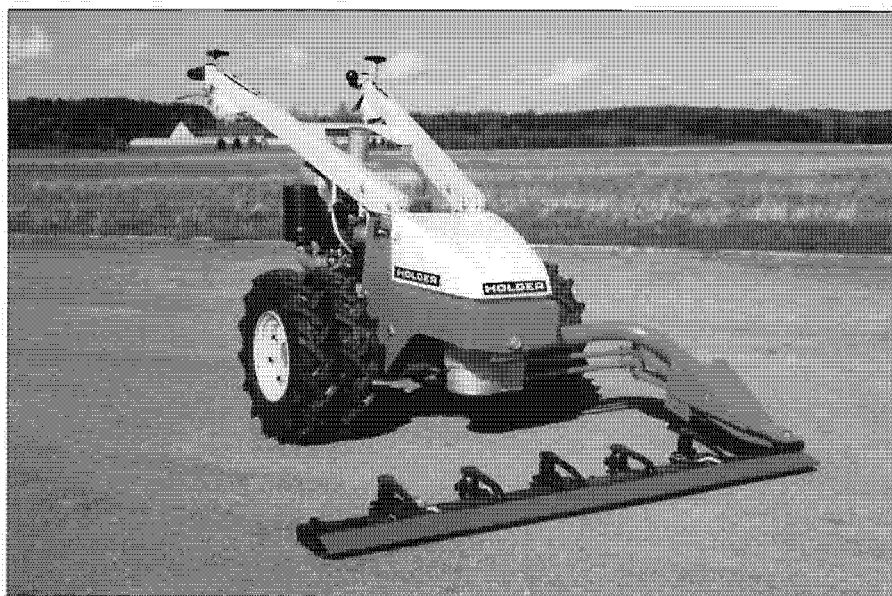
Beim Grabenmähen war der M 1000 in seinem Element: Der „Seitenantriebs-Doppelmessermäher“ mit dem „denkenden Holm“ scheute keine schwierigen Aufgaben.
