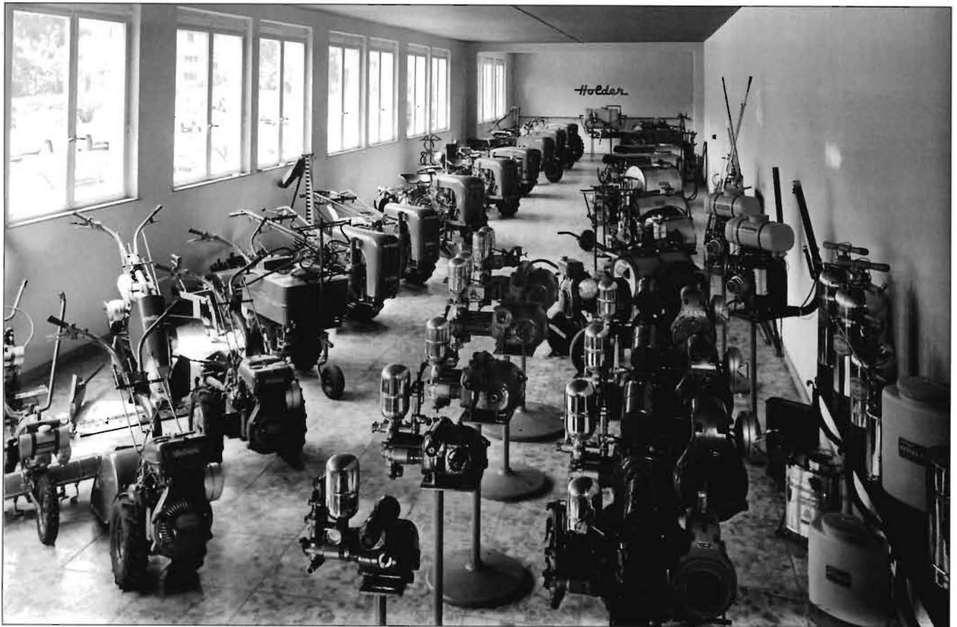
Gute 30 Jahre lang war Holder-Grunbach gut für neue Generationen von handgeführten Motormähern von 3 bis 11 PS Leistung. Den Auftakt hierzu machte 1966 der „Seitantriebs-Doppelmessermäher“ M 7.
