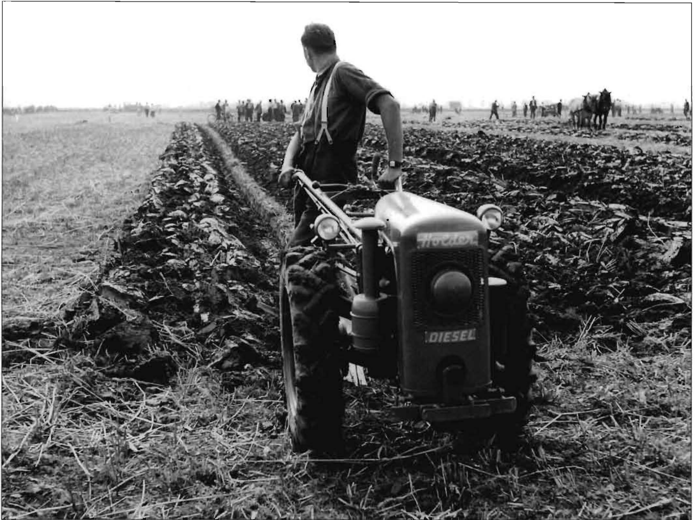
Der Diesel-Einachstraktor ED II leistete gute Arbeit mit dem Winkeldrehpflug und mit der Tieffräse, er war auch für Transportarbeiten mit seinem Anhänger sehr wertvoll. Die Liste der anbaubaren Arbeitsgeräte umfaßte rund 30 Positionen.
