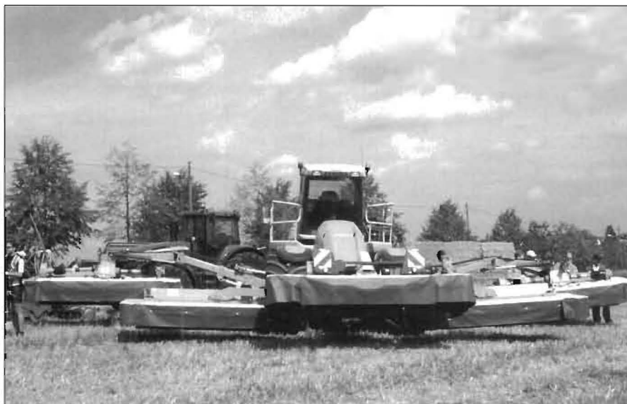
Für Großflächen konzipiert: Claas Cougar, selbstfahrendes Mähwerk (14 m Arbeitsbreite)
