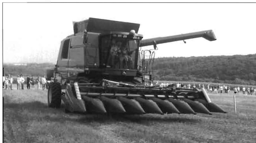
John Deere Mähdrescher 9780 CTS (336 PS) mit automatischem Lenksystem AutoTrac
