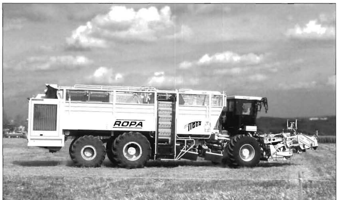
6-reihiger Köpfrödebunker von Ropa (460 PS) für Flächenleistungen bis zu 1,5 ha/h
