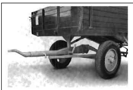
Aufsattelung durch Deichselverschiebung
