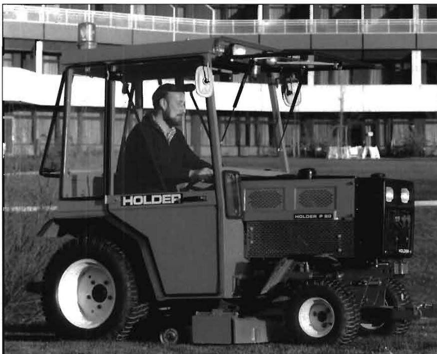
Abb. 9: Holder P 20 mit Heck- und Frontkrafthebern sowie Zwischenachs-Aushebung und Ganzjahreskabine vor der Kurklinik in Bad Urach
