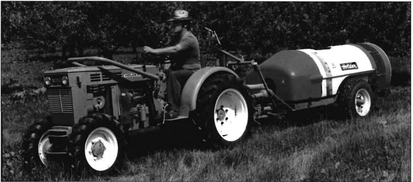
Abb. 8: Der B 51 Allradsschlepper mit Achsschenkelenkung trug schwere Anbaugeräte und kam bei der Kundschaft gut an
