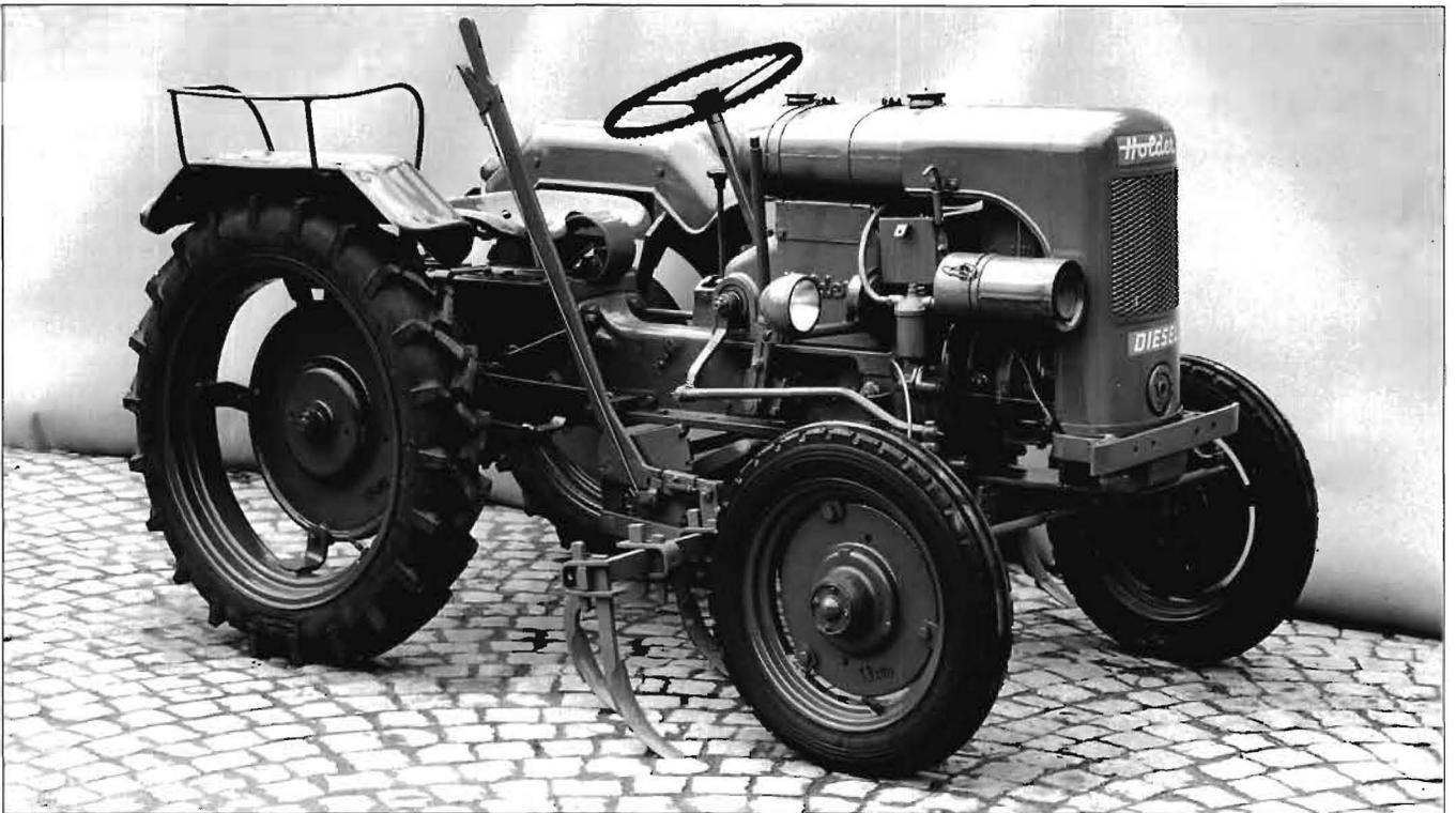
Abb.2: Der 10 PS-Schlepper B 10 wurde erstmals 1953 vorgestellt und im Laufe der Jahre mehrfach variiert. Hier: "Bauernschlepper" mit neuer Haube und Seitenmähwerk im Jahre 1955
