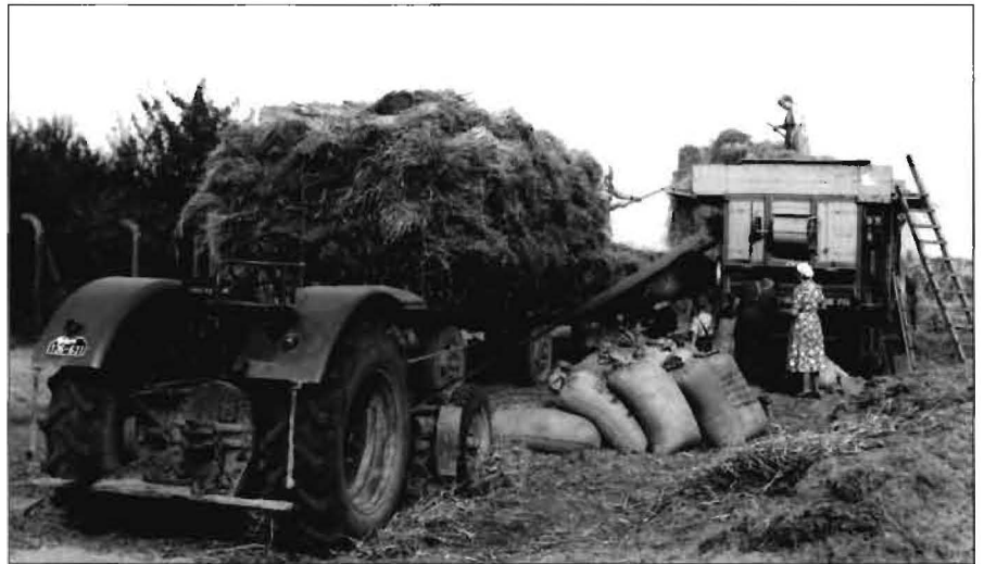
Bild 1: Beim Felddrusch musste die ganze Bauersfamilie mithelfen. Als Antrieb diente der Schleppermotor, von dessen Riemenscheibe die Kraft über Keilriemen zum Dreschkasten geleitet wurde.
