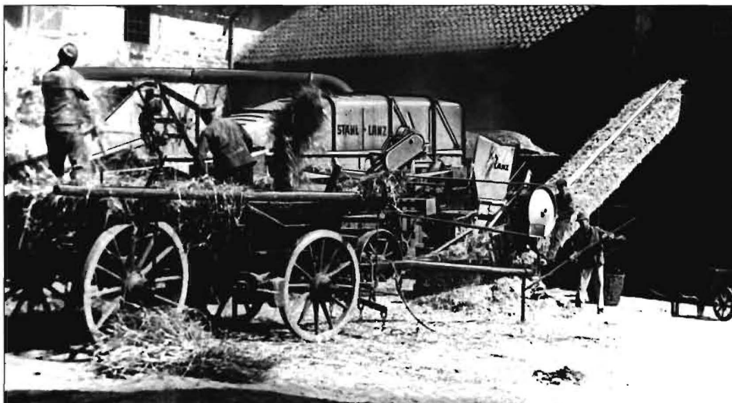
Bild 2: Auf größeren Gütern kam der Stahl-Lanz zum Einsatz, eine ganz aus Eisen gefertigte Dreschmaschine mit hohem Durchsatz und guten Druschergebnissen.
