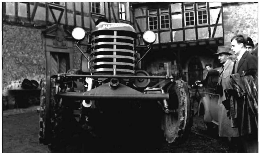
Bild 2: Die maximale Triebkraft erreichte der Alpenland-Schlepper, wenn der Kraftheber die Vorderräder vom Boden abgehoben hatte. Gelenkt wurde das Fahrzeug dann über die Hinterräder
