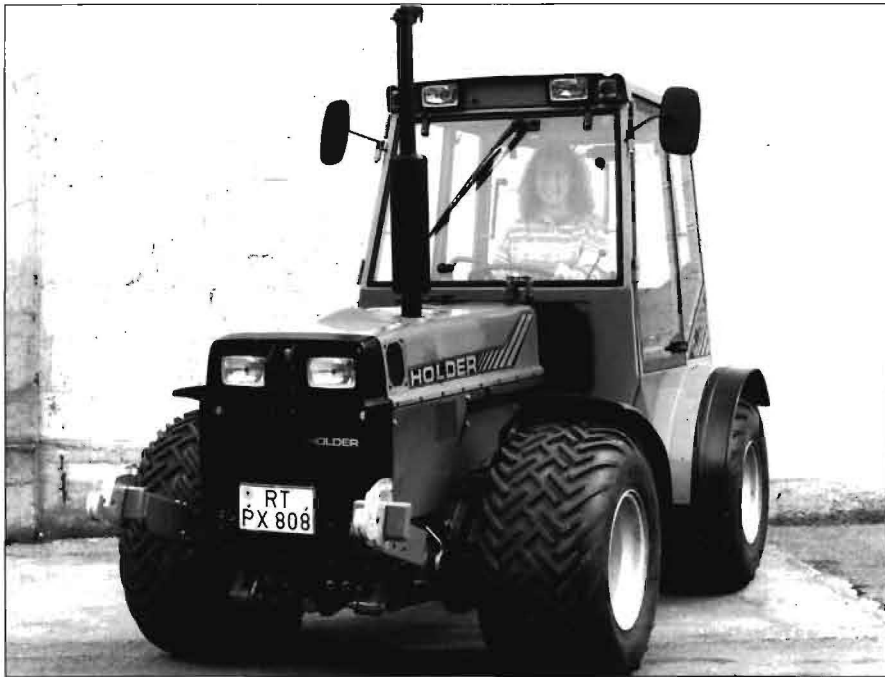
Bild 5: Mit klimatisierter Kabine und rasenschonenden Breitreifen stellt sich der Kommunal-Traktor C 760 als kompakter Geräteträger für den Ganzjahreseinsatz mit Front- und Heckdreipunkt-Hydraulik vor
