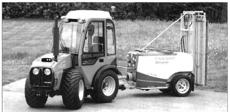
Bild 6: Ein Gespann, das sich sehen lassen kann: Der Weinbau-Schlepper A 7.74 mit klimatisierter Kabine und reichhaltiger Hydraulik-Ausstattung vor dem vollverkleideten Anhängersprühgerät Securliner mit Querstromgebläse auf der Intervitis 2004
