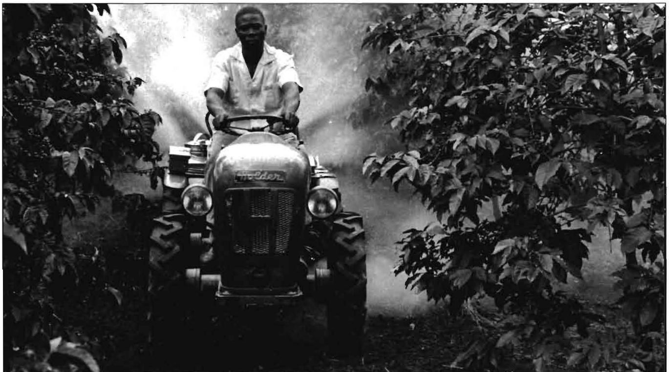
Bild 1: Laubreiche Sonderkulturen sind die typischen Tätigkeitsfelder für Holder-Allrad-Schlepper, hier ein A 12 mit Turbulator-Anbausprüngerät im Kaffeeanbau in Kenia
