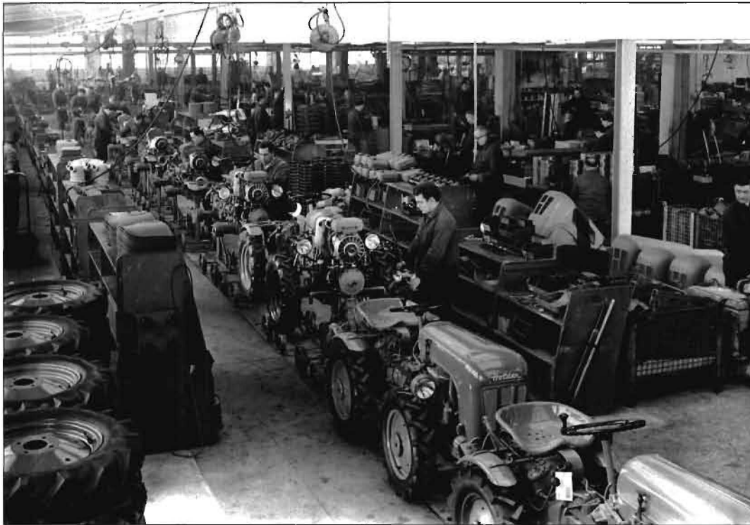
Bild 2: Ein Blick in die Montage- halle in den sechziger Jahren. Kaum ist die letzte Serie A 12 fertiggestellt, wird an der nächsten Serie A 20 mit luftgekühlten MWM-Motoren weiterge- arbeitet
