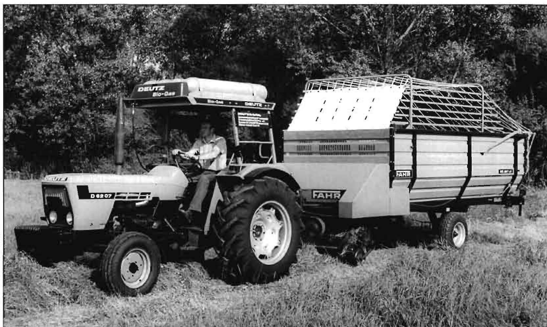
Bild 1: Deutz D 6207, umgerüstet auf Bio-Gas (1980)
