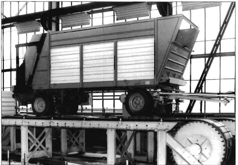
Bild 2: Verteilwagen für Futter und Einstreu L 440 auf dem Fahrwerksprüfstand
