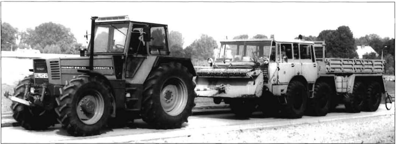
Bild 5: Zugkraftmessung des Traktors Fendt Favorit 615 LSA anlässlich des Schleppervergleichs der ZPL für „top agrar“, Aug. 1990
