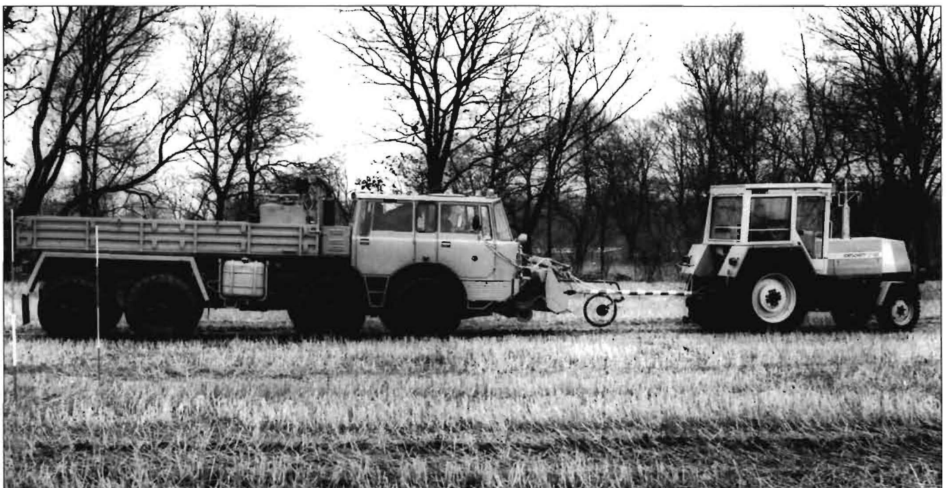
Bild 4: Zugkraftmessung des Traktors ZT 320 des Traktorenwerks Schönebeck
