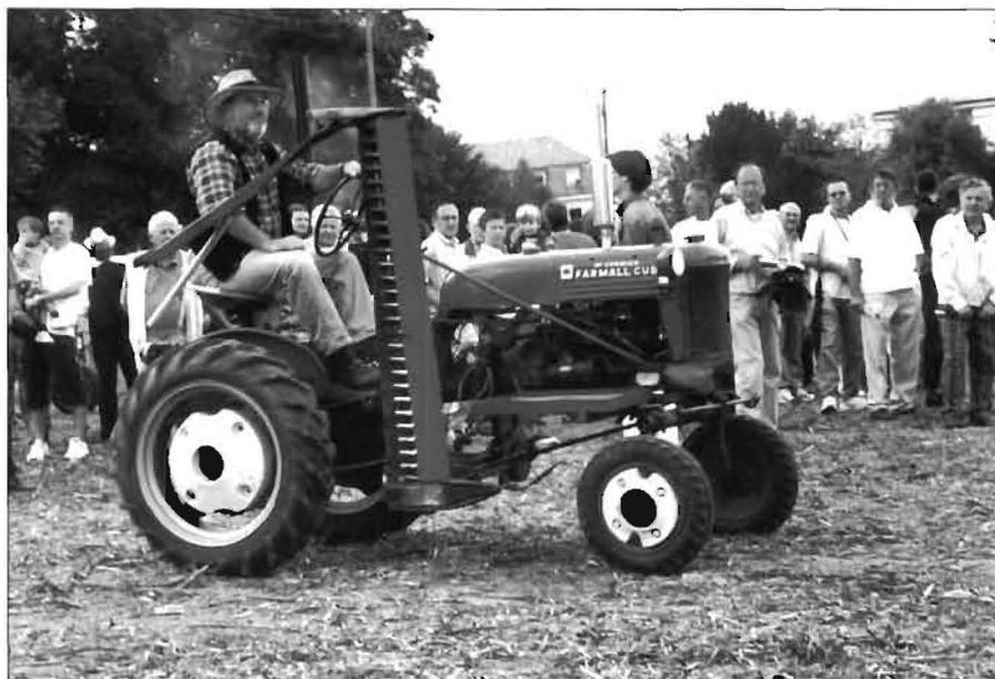
Der Farmall Cub von Etienne Gentil verfügt über einen 4-Zyl.-Benzinmotor
