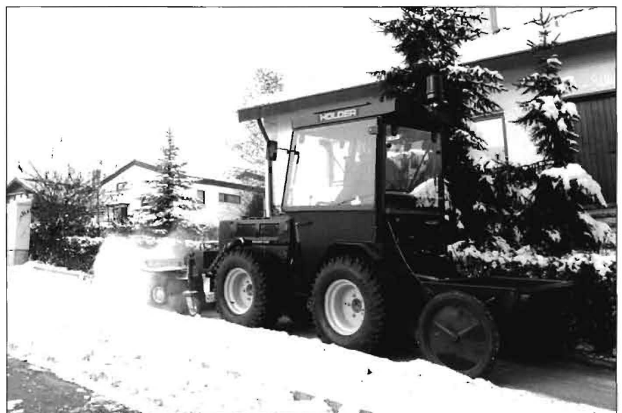
Ein C 20 Allrad-Knicklenker-Kabinenschlepper beim Schneekehren auf einem Fußweg mit einem randscharf schmal streuenden bodenangetriebenen Kastenstreuer
