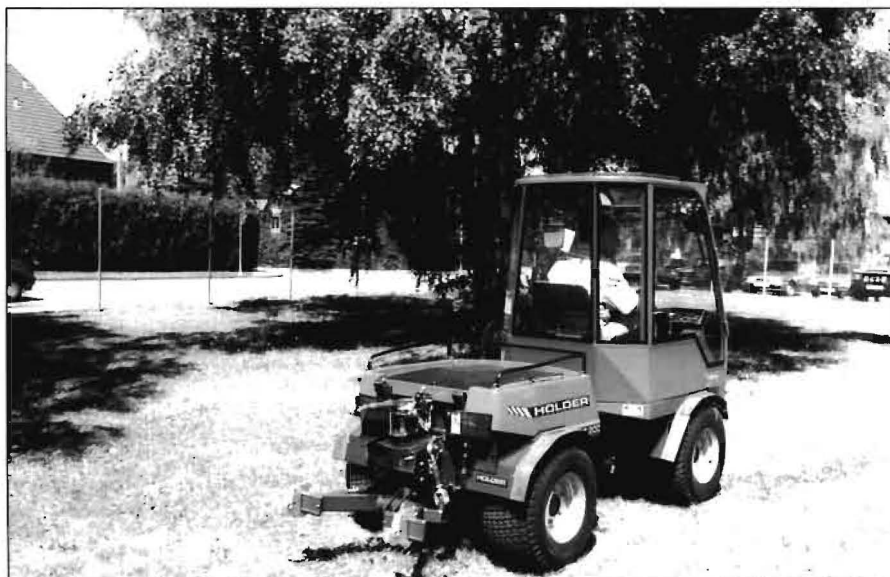
Eine Multipark C 2.40-Grundmaschine mit Rasenreifen. Immer wieder bestätigt sich, daß optimale Sicht auf Frontgeräte sehr wertvoll ist. Auf der praktischen Motorraum-Abdeckung mit Reling läßt sich Zubehör gut transportieren
