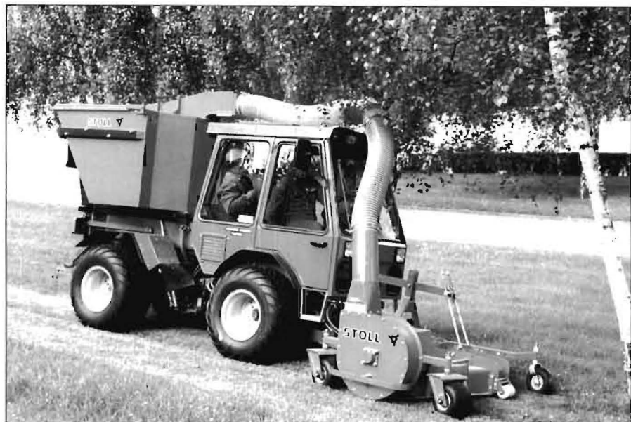
Ein C 6000 mit hydrostatischem Fahrtrieb bei der Rasenpflege mit einer Stoll-Mäh- und Lade-Kombination mit Hochkip-Entleerung auf Lastwagen: Bei Stadtgartenämtern und beim Personal sind solche Frontmäher durchaus beliebt
