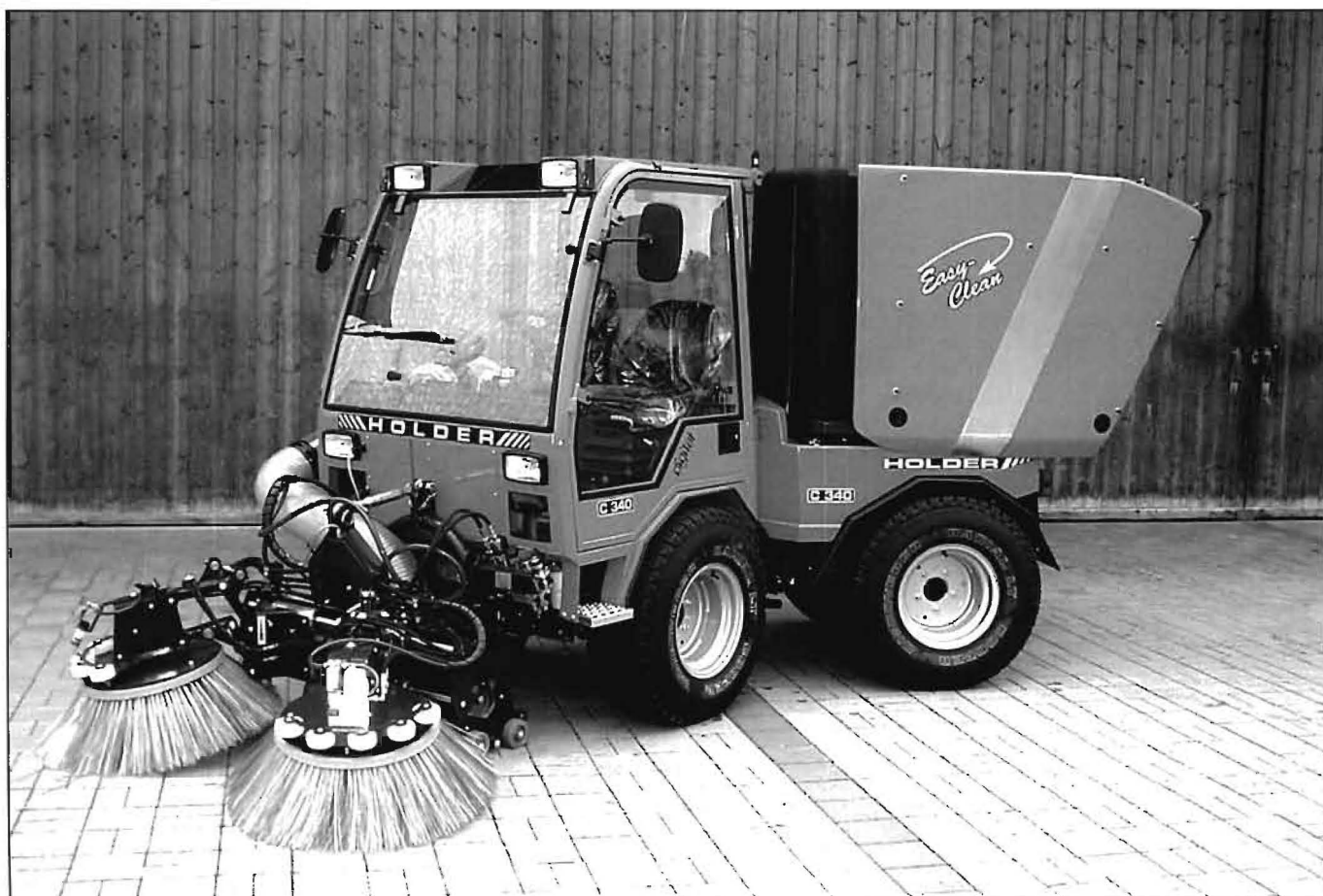
Ein Multipark C 3.42 als wendige Kehrsaugmaschine. Direkt hinter den seitenverstellbaren Tellerbesen befindet sich der Saugmund. Der Saugschlauch hat eine rotierende Klarsichtstrecke, der Fahrer erkennt etwaige Verstopfungen rechtzeitig
