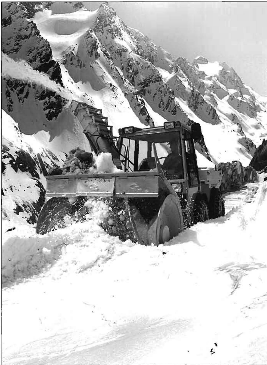
Das Flaggschiff der Frontsitz-Knicklenker von Holder: Der C 9.88 (65 kW/ 88 PS) mit einer Zaugg-Schneefräse mit einem nach Richtung und Wurfweite hydraulisch verstellbaren Auswurfbogen
