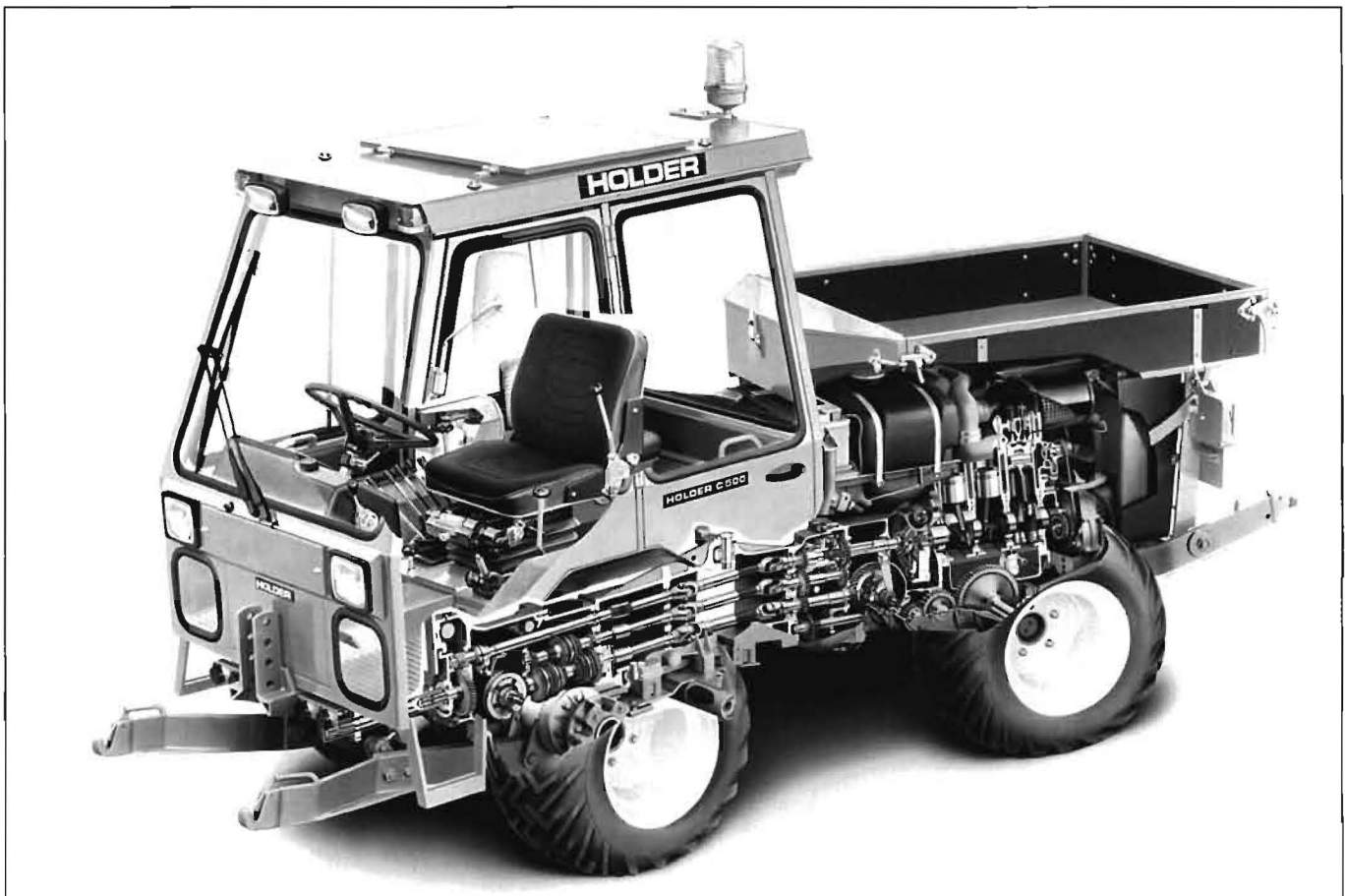
Der C 500 Schmalspur-Knicklenker im Schnittbild: Ein nahezu perfekter Kommunal-Geräteträger mit Zweimann-Kabine sowie drei Anbau- bzw. Aufbauräumen im Frontdreipunkt, über dem Motorraum und im Heckdreipunkt
