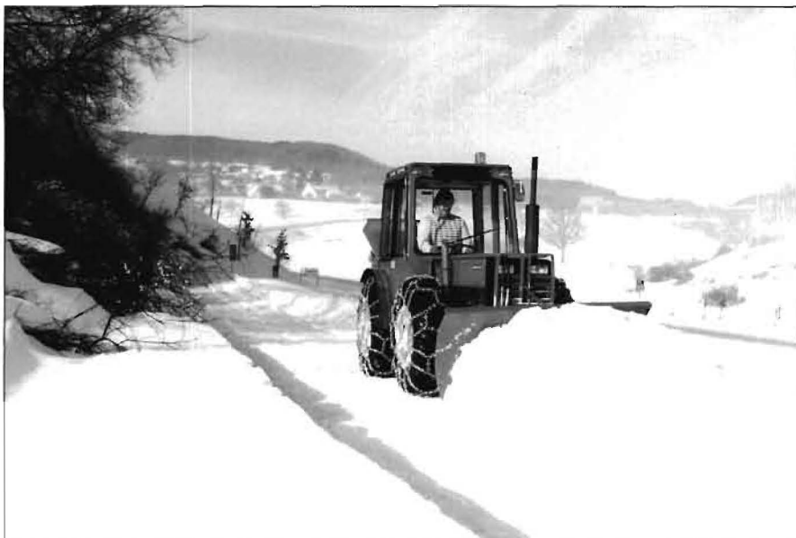
Eine starke Arbeitseinheit: Ein Holder C 65 Turbo (43 kW/ 59 PS) mit Schneeketten und gelber Rundumleuchte beim Schneeräumen und Streuen mit Schleuderstreuer
