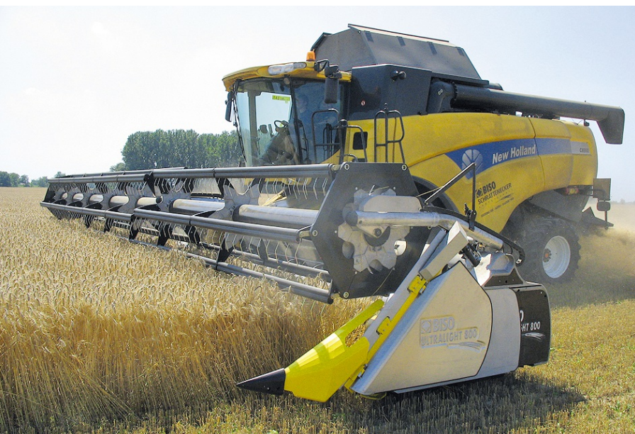
Biso. Mährescher-Schneidwerk in Alu-Bauweise
