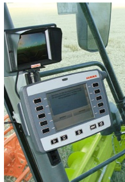
Claas. Interaktives System zur Mähdrüsch-Einstellung
