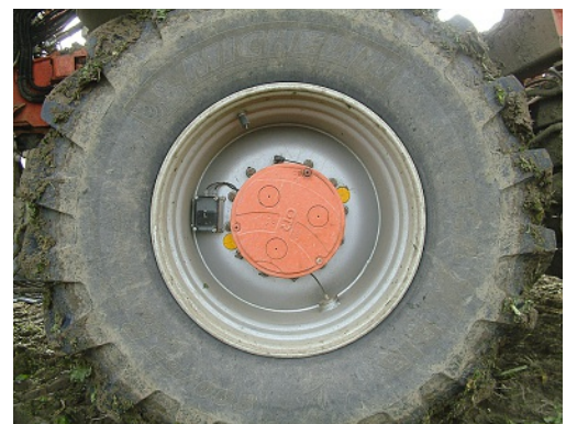
Grasdorf Wennekamp. Erfassen der lastabhängigen Reifeneinfederung
