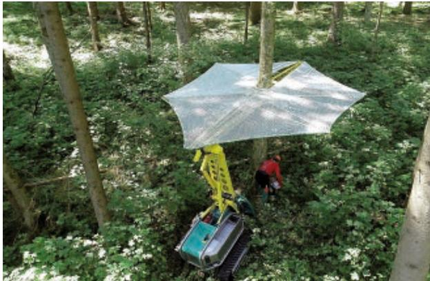
nenteile. Der Personen-Schutzschirm ist an einer Forstraupe Moritz befestigt und wird vor dem Baum stehend hydraulisch ausgeklappt. Der sich in ca. 2 m Höhe um den Baum herum schließende Schirm schützt die fallende Person insbesondere in der Vorbereitungsphase der Fällung zuverlässig. Gleichzeitig kann die Hydraulik der Raupe bei der eigentlichen Fällung, für die der Schirm dann einseitig wieder geöffnet wird, zur Fällunterstützung verwendet werden. Im
