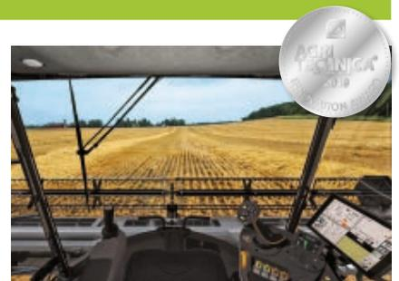
Arbeitsmaschine mit vollständiger Joystickbedienung. Neben der verbesserten Sicht erhöhen sich Wendigkeit und Bedienkomfort bei der Erntearbeit sowie die Übersicht bei Straßenfahrt und somit die Sicherheit. Insgesamt leistet die Technik, ähnlich wie im Baumaschinenbereich, einen Beitrag zur Steigerung der Effizienz des Mähdrusches.
