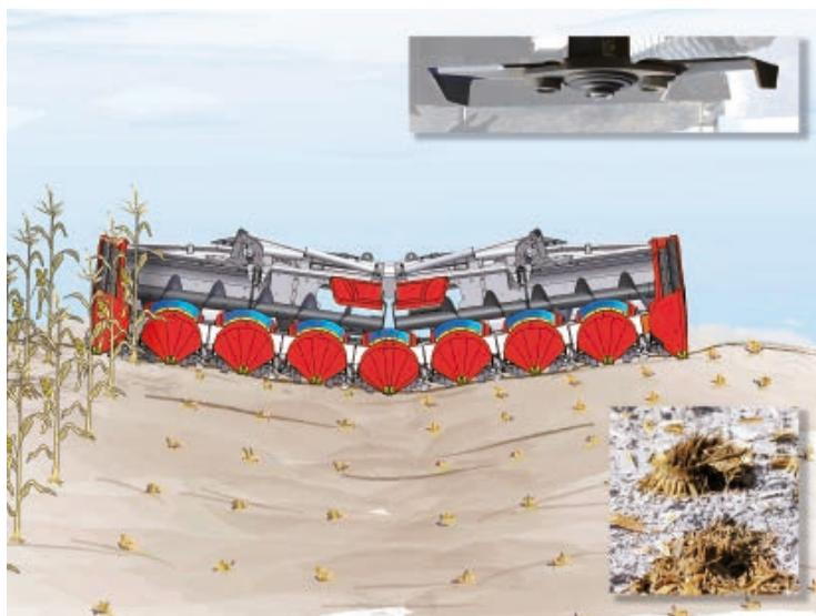
Maisstoppeln müssen die Rotoren mit kürzester Distanz zur Bodenoberfläche geführt werden. Dazu hat Geringhoff den Rahmen des Maispflückers Horizon Star III Razor in der Mitte mit einem Drehgelenk versehen. Der mittlere Bereich mit dem Schrägförderer des Mähreschers sowie die beiden Seitenbereiche werden sensorisch tiefengeführt. Damit leistet der Maispflücker Horizon Star III einen wesentlichen Beitrag zur Verbesserung des Pflanzenschutzes im Körnermaisbau.
