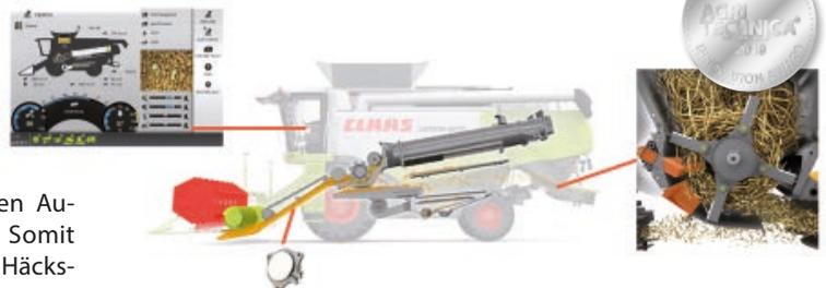
genschneide und Reibleiste zur Reinigung hin und her- und bei kurzfristig drohenden Überlastungen ausgeschwenkt. Mit CEMOS Auto Chopping gelangt kontinuierlich so viel Leistung wie nötig, aber so wenig Leistung wie möglich in den Strohhäckslers. Dies spart im Vergleich zu bisherigen Einstelltechniken Kraftstoff und bietet gleichzeitig acker- und pflanzenbauliche Vorteile.
