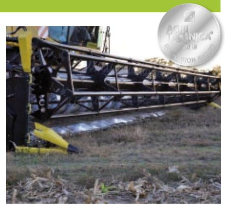
Messerbalkens zur Verfügung, das anstelle eines konventionellen Schneidwerkes mit variabler Schneidtschlänge und eines Flexschneidwerkes genutzt werden kann und somit Kosten spart.
