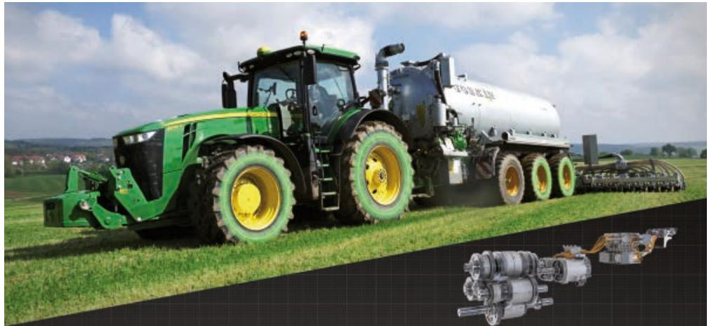
in der Landtechnik dar. Technisch wird auf die Hydroeinheit (Pumpe/Motor) komplett verzichtet, stattdessen kommen zwei E-Maschinen als stufenloses Stellglied zum Einsatz. Die E-Maschinen sind so dimensioniert, dass sie nicht nur den Fahrtrieb versorgen, sondern zusätzlich bis zu 100 kW elektrische Leistung für externe Verbraucher bereitstellen können. Die dadurch mögliche Traktor-Geräte-Elektrifizierung
