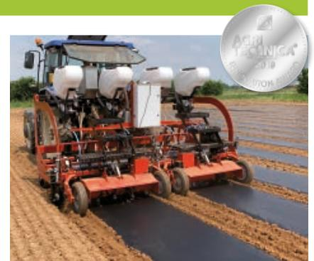
tem ist für großkörniges Saatgut wie Mais oder Soja optimiert. Mit der Verringerung der Lochgröße in der Folienbedeckung der Saatreihe geht eine deutliche Reduktion des Unkrautauftkommens nach dem Durchbrechen der Jungpflanzen einher. Dadurch reduziert sich der Aufwand zur Bestandspflege.
