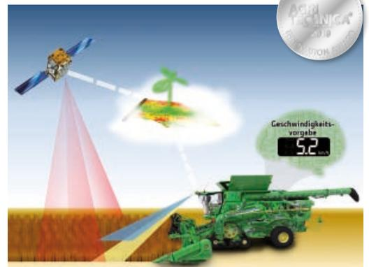
seine Fahrgeschwindigkeit wie auch seine Einstellungen auf die Erntesituation ein. Der vorausschauende Mähdrischer arbeitet erstmalig automatisch ebenso wie ein von einem vorausschauenden, versierten Fahrer bedienter Mähdrischer. John Deere hat mit dieser Technik einen großen Schritt in der Weiterentwicklung der Automatisierung der Druschfruchternte vollzogen.
