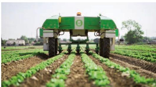
(zwischen den Kulturpflanzen). Besonders bei Produktionsverfahren, in denen keine Herbizide eingesetzt werden, können diese Bereiche nur mit einem sehr hohen Arbeitskraftaufwand händisch unkrautfrei gehalten werden. Der Roboter Dino in Kombination mit dem Präzisions-Unkrautbekämpfungsgerät ist das erste autonome Gerät, das zur mechanischen Unkrautbekämpfung in den Salatzeilen eingesetzt werden kann. Die Maschine lokalisiert
